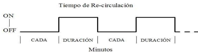
Este proceso garantiza el suministro inmediato de agua caliente en las habitaciones. Realiza un proceso de constante recirculación del agua en la tubería para mantenerla a la temperatura deseada.
