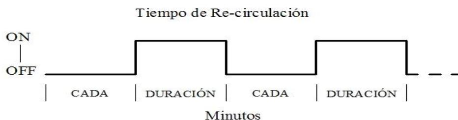
Este garantiza el suministro inmediato de agua caliente en las habitaciones. Realiza un proceso de constante re-circulación del agua en la tubería para mantenerla a la temperatura ajustada.
